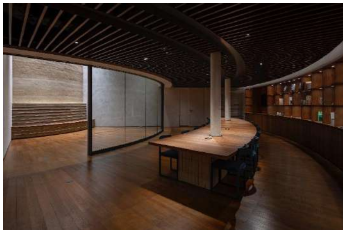
O社ギャラリー 現場土を用いた版築ベンチと現場土を多治見で焼いたタイル
