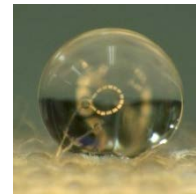
図 7-C 本研究における疎水化処理 での代表的処理試料上の水滴形状
